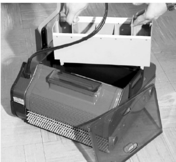
Abb. 14: Aufnahmebehälter für das Schmutzwasser
