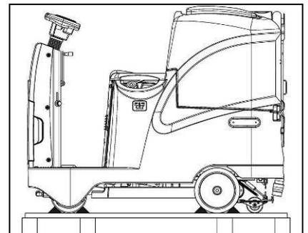
5. Mit Hilfe einer kleinen Stützrampe, die Maschine rückwärts von der Palette schieben. Montieren Sie nicht den hinteren Saugfuß, bevor die Maschine entladen wurde, um heftige Stöße gegen den Bürstenkopf zu vermeiden. Für die Montage des Saugfußes wird auf den Abschnitt "MONTAGE DES SAUGFUßES" verwiesen.
