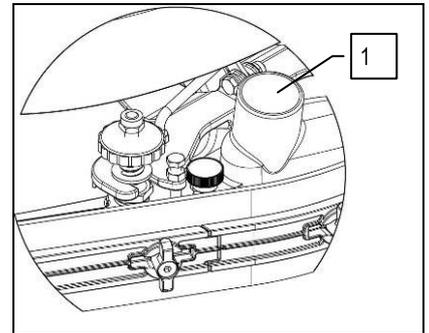
4. Ziehen Sie den Saugschlauch aus dem Sitz am Schmutzwassertank (2)
