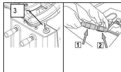
6. Führen Sie mit dem Schlüssel des Hauptschalters eine Vierteldrehung im Uhrzeigersinn aus (auf I stellen). Dadurch schaltet sich sofort das Display am Instrumentenbrett ein.
