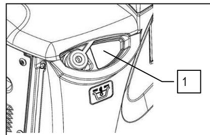
Prüfen Sie, ob der Verschluss des Reinigungslösungsfilters (2), der unter dem Reinigungsmittel tank im linken vorderen Teil des Geräts angebracht ist, richtig verschlossen ist.
