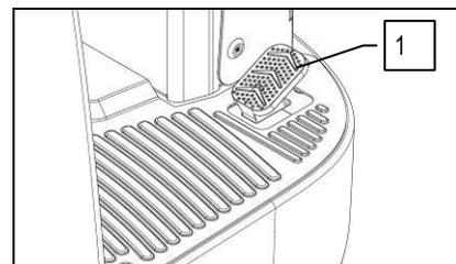
Zum Fahren im Rückwärtsgang müssen Sie nur die am Instrumentenbrett vorhandene Taste (2) drücken, sofort danach das Gangpedal (1) drücken, die Geschwindigkeit wird durch stärkeres oder weniger starkes Drücken des Pedals reguliert.
