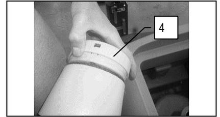
6. Entfernen Sie den Saugfilter (5) vom Schwimmerkörper
