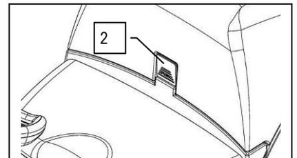
5. Ergreifen Sie den Schmutzwassertank und drehen Sie ihn bis zum Endanschlag
