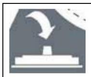
Symbol für abgesenkten Saugfuß. Es wird auf der Rückseite der Maschine verwendet, um die Position anzuzeigen, an der das Hebekabel des Saugfußes angebracht werden soll.
