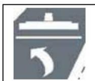
Symbol für angehobenen Saugfuß. Wird auf der Rückseite der Maschine verwendet, um die Position anzuzeigen, an der das Saugfuß-Hebekabel angebracht werden muss.
