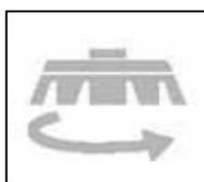
Symbol für die Wischerblatt-Deaktivierung. Wird auf der Instrumententafel verwendet, um den Knopf zur automatischen Wischerdeaktivierung anzuzeigen.
