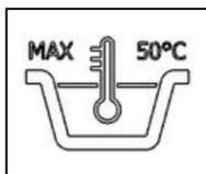
Gibt die maximale Temperatur der Reinigungslösung an. Es befindet sich in der Nähe der Ladeöffnung des Lösungstanks.
