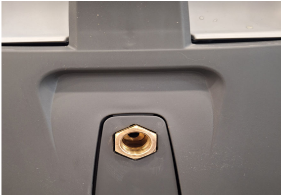
Abb. 6: Gewindebohrung am Hochdruckreiniger
