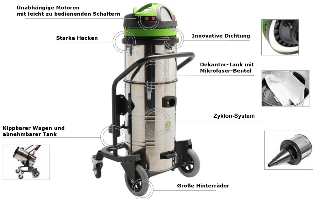
Abb. 3: Beschreibung des Trockensaugers flexCAT 378 CYC-PRO
