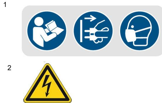
Abb. 1: Sicherheitshinweise - 1 Gebotszeichen: Anleitung beachten, Stecker ziehen, Maske benutzen | 2 Warnung vor elektrischer Spannung
