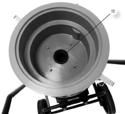
Abb. 14: Dichtung des Zyklonmoduls
