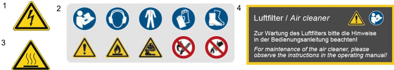
Abb. 1-1: Sicherheitskennzeichnungen - 1 Elektrische Spannung | 2 - Betriebsanleitung beachten, Gehörschutz tragen, Schutzkleidung benutzen, Handschutz benutzen, Fußschutz benutzen, allgemeines Warnzeichen, Warnung vor feuergefährlichen Stoffen, Gefahr des Ersticken durch Sauerstoffmangel, keine offene Flamme, mit Wasser löschen verboten | 3 Warnung vor heißer Oberfläche | 4 Luftfilter-Hinweis
