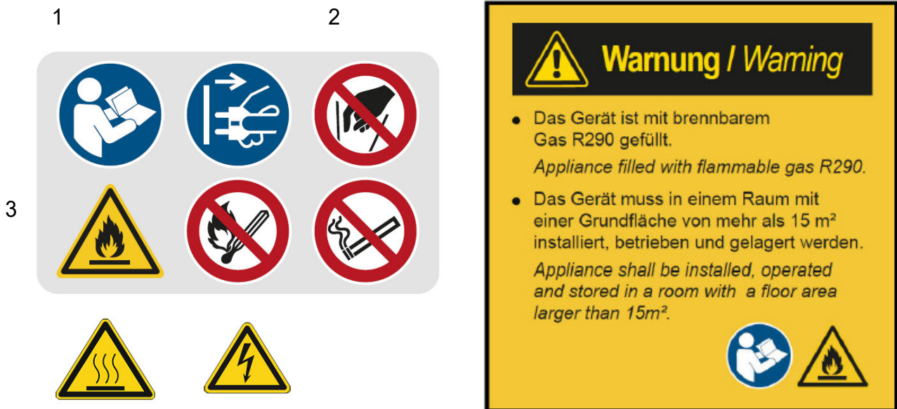
Abb. 1-1: Sicherheitskennzeichnungen: 1 Gebotszeichen: Gebrauchsanweisung beachten, Netzstecker ziehen | 2 Verbotssymbole: Hineinfassen verboten, keine offene Flamme; Feuer, Rauchen verboten | 3 Warnzeichen: Warnung vor feuergefährlichen Stoffen, Warnung vor heißer Oberfläche, Warnung vor elektrischer Spannung
