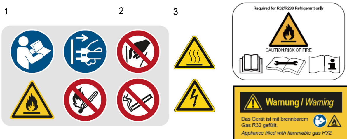
Abb. 1-1: Sicherheitskennzeichnungen: 1 Gebotszeichen: Gebrauchsanweisung beachten, Netzstecker ziehen | 2 Verbotsschilder: Hineinfassen verboten, keine offene Flamme; Feuer, Rauchen verboten | 3 Warnzeichen: Warnung vor feuergefährlichen Stoffen, Warnung vor heißer Oberfläche, Warnung vor elektrischer Spannung |
