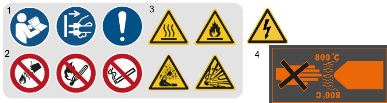
Abb. 1-1: Sicherheitskennzeichnungen: 1 Gebotszeichen: Gebrauchsanweisung beachten, Netzstecker ziehen, allgemeines Gebotszeichen | 2 Verbotssymbole: mit Wasser löschen verboten, keine offene Flamme; Feuer, Rauchen verboten | 3 Warnzeichen: Warnung vor heißer Oberfläche, Warnung vor feuergefährlichen Stoffen, Warnung vor elektrischer Spannung, Warnung vor Ersticken, Warnung vor explosionsgefährlichen Stoffen
