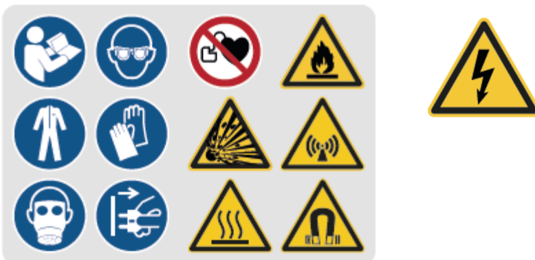
Abb. 1-2: Sicherheitskennzeichnungen - 1: Gebotszeichen - Anleitung beachten, Augenschutz benutzen, Schutzkleidung tragen, Handschutz benutzen, Atemschutz benutzen, Netzstecker ziehen | Verbotsschilder: Kein Zutritt für Personen mit Herzschrittmachern oder implantierten Defibrillatoren | Warnhinweise: Warnung vor explosionsgefährlichen Stoffen, Warnung vor heißer Oberfläche, Warnung vor feuergefährlichen Stoffen, Warnung vor nichtionisierender Strahlung, Warnung vor magnetischem Feld | 2: Warnung vor elektrischer Spannung
