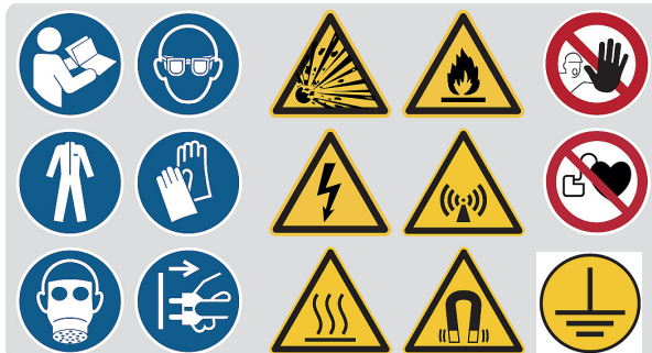
Abb. 1: Sicherheitskennzeichnungen am Induktionsheizgerät I
