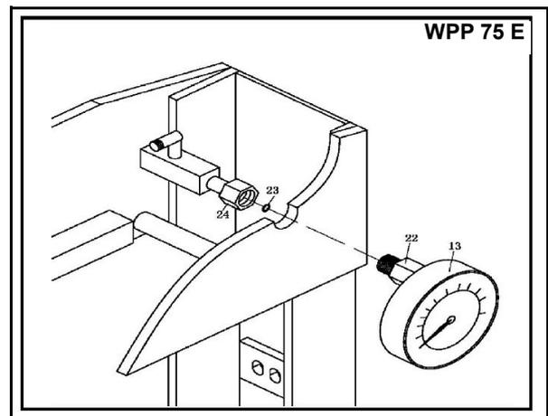
Abb. 10: Manometer montieren
