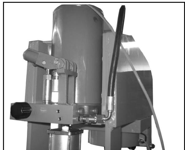
Abb. 15: Der kurze Schlauch montieren
