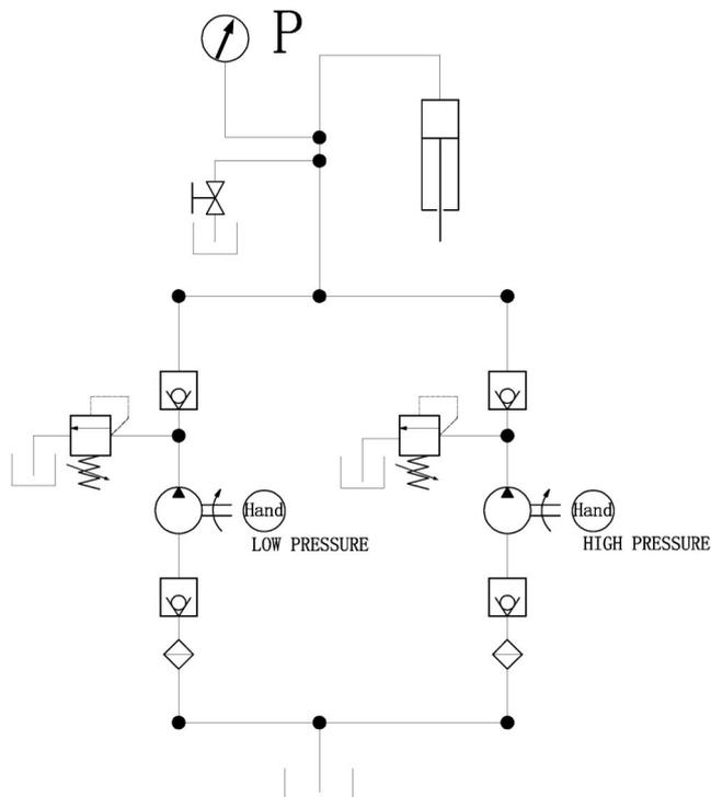
Abb. 29: Hydraulik-Schaltplan WPP 15 E (oben) und 20 E (unten)
