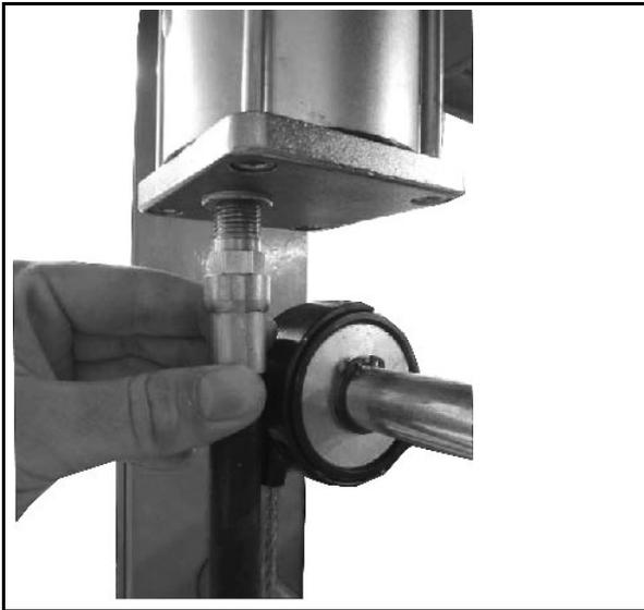
Abb. 17: Druckluftverbindung montieren
