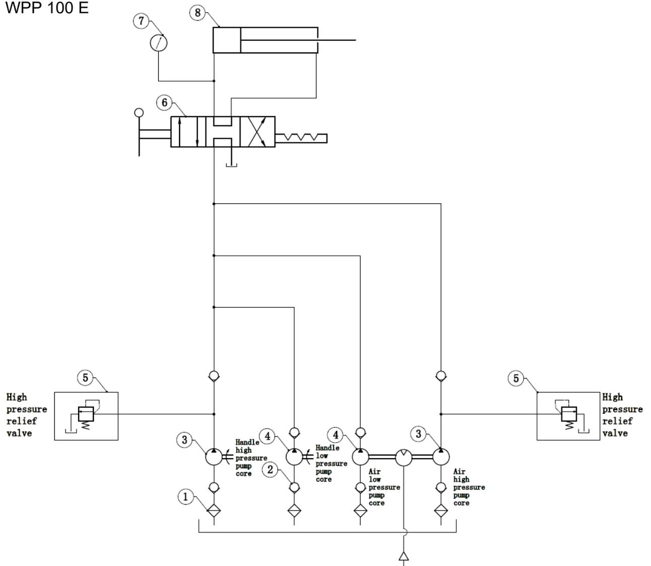
Abb. 32: Hydraulikplan der Werkstattpresse WPP 100 E
