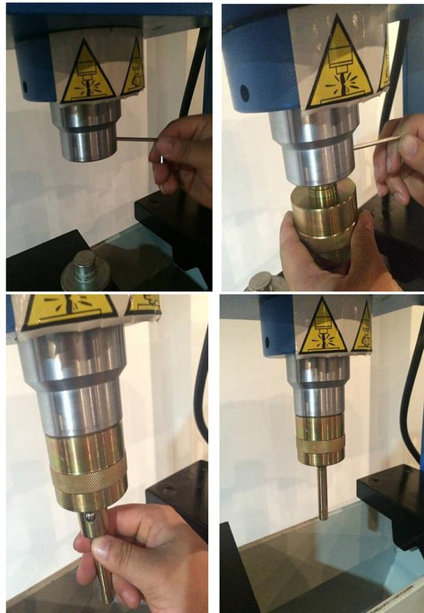
Abb. 19: Druckdornsatz montieren
