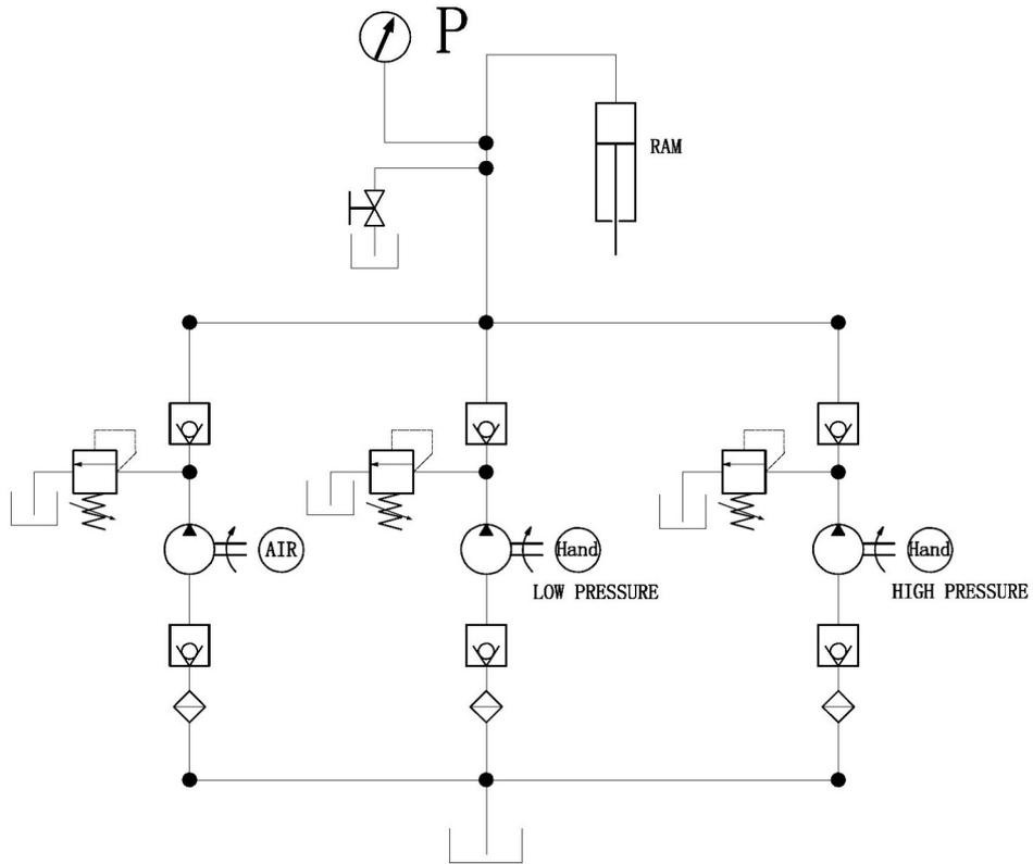
Abb. 30: Hydraulik-Schaltplan WPP 30 E, WPP 50 E
