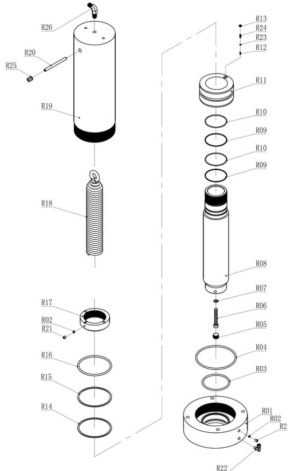
Abb. 26: Zylinder der hydraulischen Werkstattpresse WPP 20 E (oben links), WPP 30 E (oben Mitte), WPP 15 E (oben rechts); WPP 50 E und WPP 75 E (unten rechts); Pumpe WPP 50 E (unten links)
