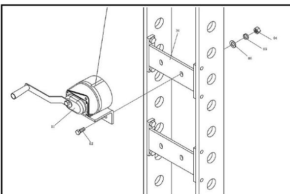
Abb. 18: Seilwinde montieren
