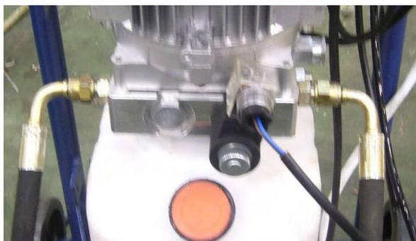
Abb. 13: Anschluss an der Hydraulikpumpe
