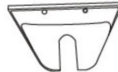
Schritt 4: Entfernen Sie die Abdeckung an beiden Seiten der Heizstrahler-Kassette
