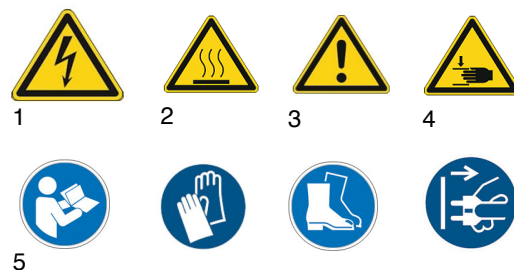
Abb. 1: Sicherheitskennzeichnungen am Infrarot-Lackrockner I 1 Warnung vor gefährlicher elektrischer Spannung I 2 Warnung vor heißer Oberfläche I 3 Warnung vor einer Gefahrenstelle I 4 Quetschgefahr I 5 Gebotszeichen: Betriebsanleitung beachten, Schutzhandschuhe tragen, Sicherheitsschuhe tragen, Netzstecker ziehen
