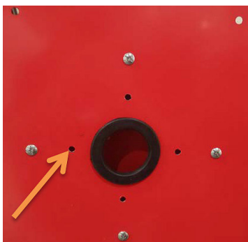
Abb. 7: Bohrungen zum Anschluss der Sandstrahlkabine
