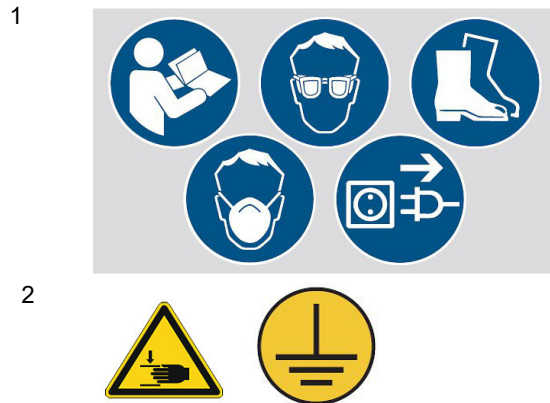
Abb. 1: Sicherheitskennzeichnungen an der Sandstrahlkabine SSK 5 1 Gebotszeichen: Anleitung beachten, Augenschutz benutzen, Fußschutz benutzen, Maske benutzen, Netzstecker ziehen | 2 Warnzeichen: Warnung vor Handverletzungen, Vor Benutzung erten
