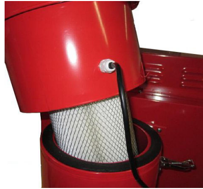
Abb. 7: Filter der Sandstrahlkabine SSK 4
