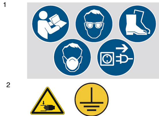
Abb. 1: Sicherheitskennzeichnungen an der Sandstrahlkabine SSK 4 1 Gebotszeichen: Anleitung beachten, Augenschutz benutzen, Fußschutz benutzen, Maske benutzen, Netzstecker ziehen 2 Warnzeichen: Warnung vor Handverletzungen, Vor Benutzung erden
