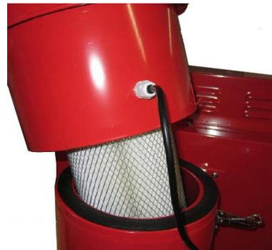
Abb. 6: Filter der Sandstrahlkabine SSK 2.5
