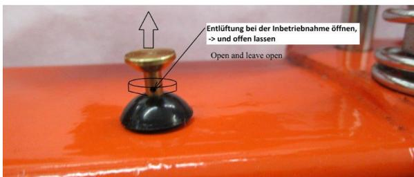
Abb. 4: Entlüftungsventil
