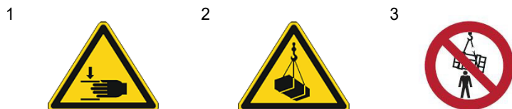
Abb. 1-1: Sicherheitskennzeichnungen - 1 Quetschgefahr | 2 Warnung vor schwebender Last | 3 Aufenthalt unter schwebender Last verboten
