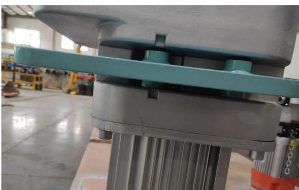
Abb. 10: Montage der Verbindungsplatte
