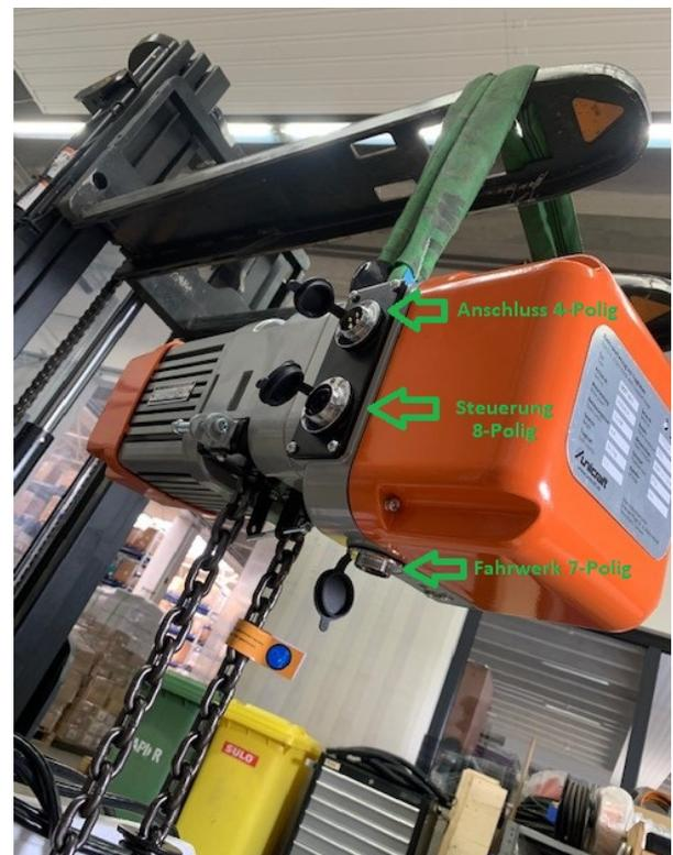
Abb. 9: Verbindung der Anschlüsse
