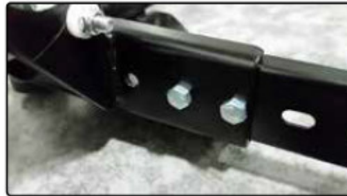
Abb. 12: Montage der Seitenschienen
