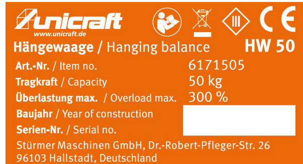
Abb. 2: Typenschild der Hängewaage HW 50
