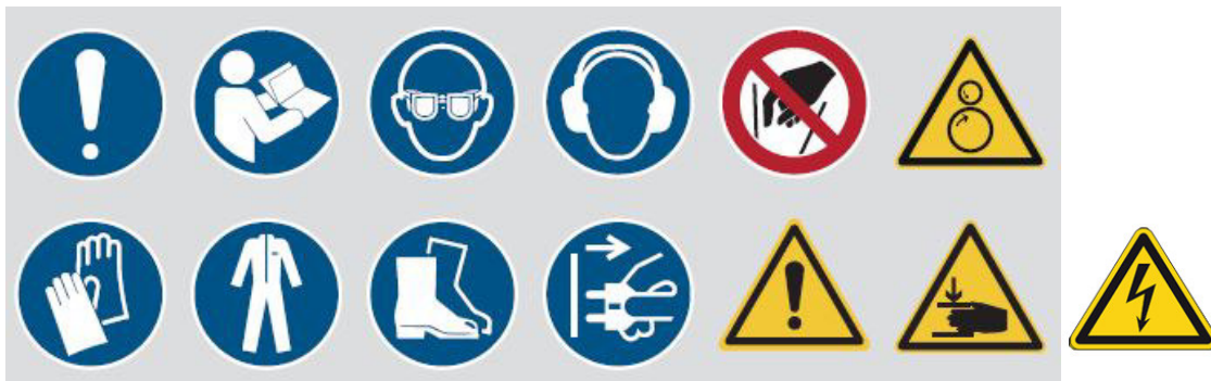
Abb. 1-2: Sicherheitskennzeichnung - Verbotssymbole: Hineinfassen verboten! | Gebotsymbole: Gebrauchsanweisung beachten, Netzstecker ziehen, Augenschutz benutzen, Gehörschutz benutzen, Fußschutz benutzen, Handschutz benutzen, Schutzkleidung benutzen | Warnsymbole: Warnung vor Handverletzungen, Warnung vor elektrischer Spannung, Warnung vor gegenläufigen Rollen!
