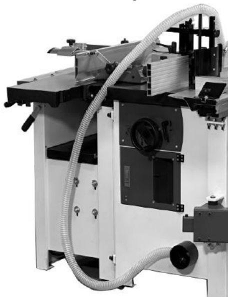
Abb.5-1: Absaugung Säge (links) und Absaugung Fräse (rechts)
