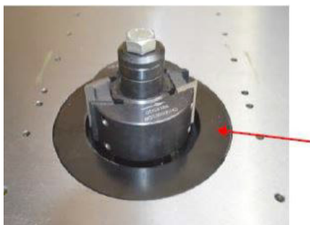
Abb.8-6: Montage einer Messerwelle
