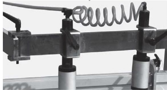
Abb. 12: Montage von Druckluftschläuchen
