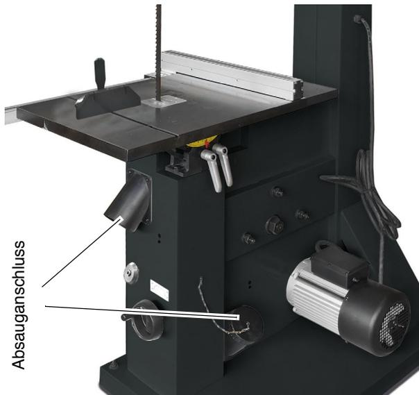
Abb. 15: Montage Absaugschlauch
