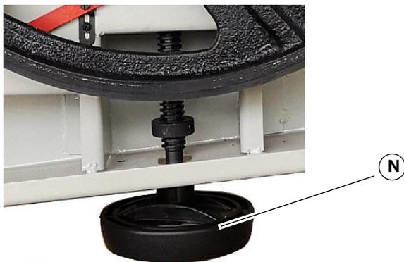
Abb. 19: Sägeband spannen
