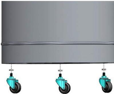
Abb. 10: Transportrollen montieren
