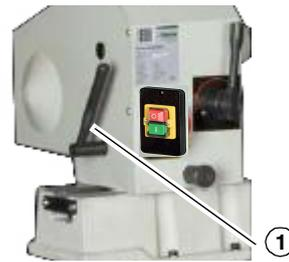
Bei der DB 1100 ist der Klemmhebel (Pos.1) auf der Rückseite des Spindelstockes einzuschrauben.
