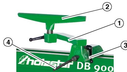
Abb. 17: Einstellen der Werkzeugauflage
