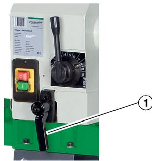
Abb. 10: Montage der Spindelstockklemmung
