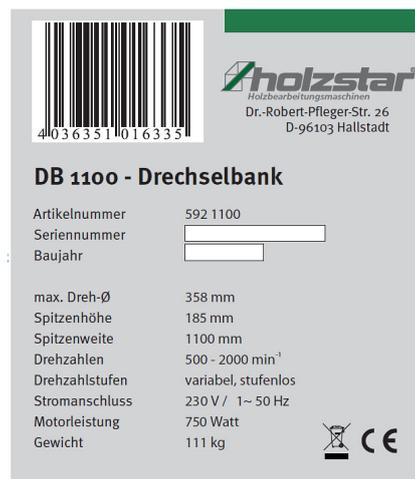
Abb. 2: Typenschild DB 1100
