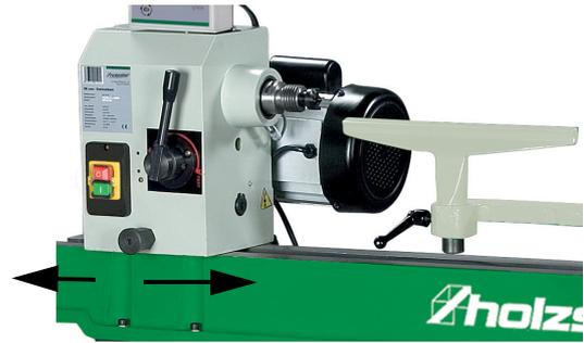
Abb. 15: Spindelstock verschieben.
