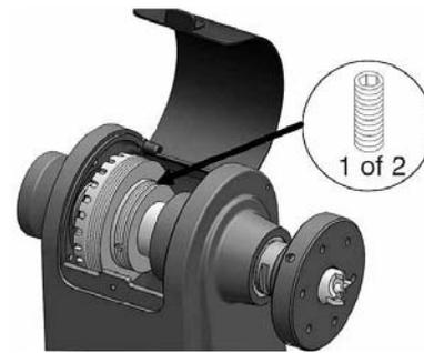
Abb. 34: Stellschrauben lösen
