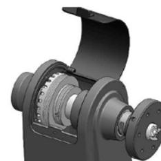
Abb. 33: Riemensabdeckung öffnen
