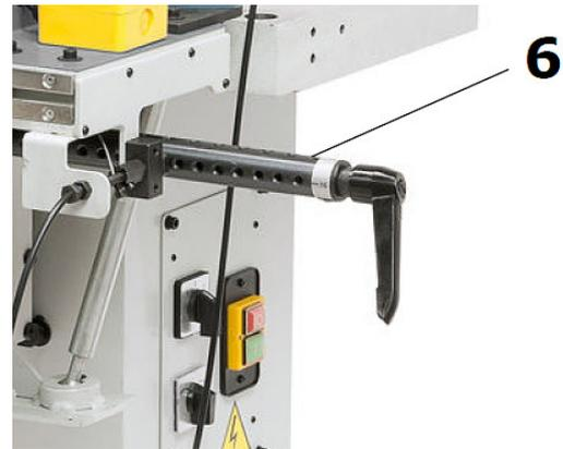
Abb. 24: Dübelbohrereinrichtung
