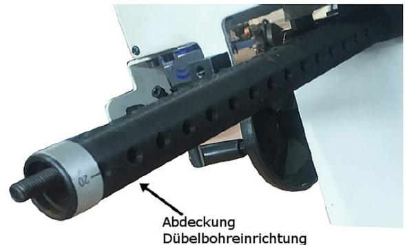
Abb. 9: Montage Abdeckung Dübelbohr-einrichtung
