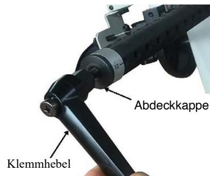
Abb. 10: Befestigung Dübelbohr-einrichtung
