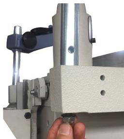
Abb. 13: Befestigen der Halterungsstange
