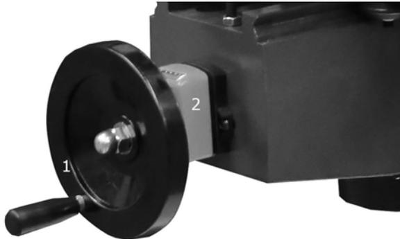
Abb. 5: Einstellen der Spindelhöhe über das Handrad
