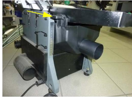
Abb. 8: Montage Späneabsaughaube
