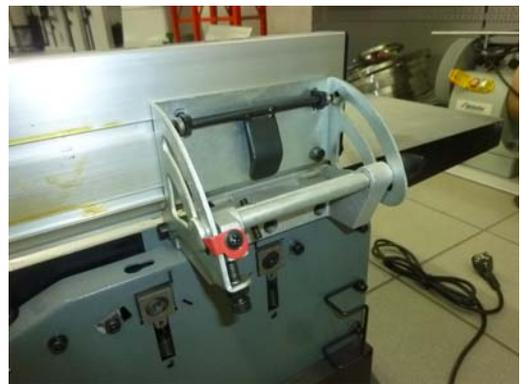
Abb. 9: Einstellung Aluminium-Abrichtanschlag
