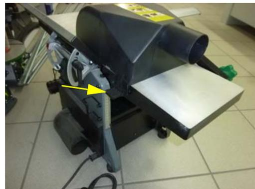
Abb. 12: Montage Späneabsaughaube
