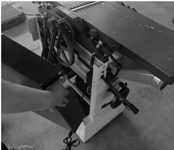
Abb. 31: Maschinenabdeckung entfernen
