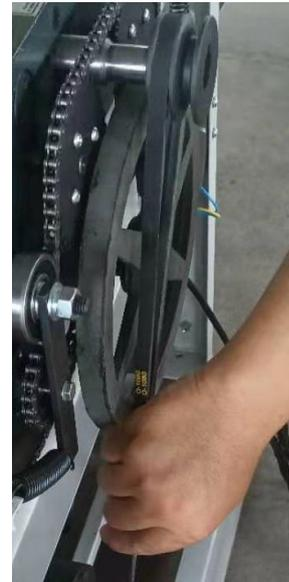
Abb. 33: Riemen entfernen
