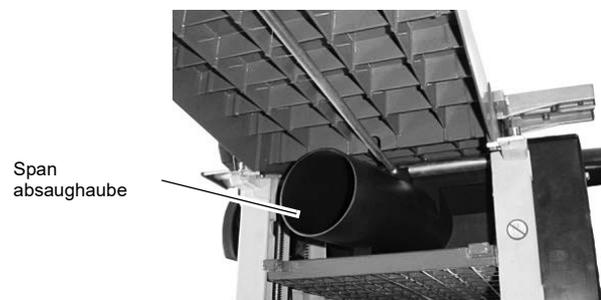
Abb. 24: Einsetzen Spanabsaughaube
