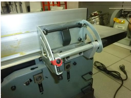
Abb. 26: Einstellung Aluminium-Abrichtanschlag
