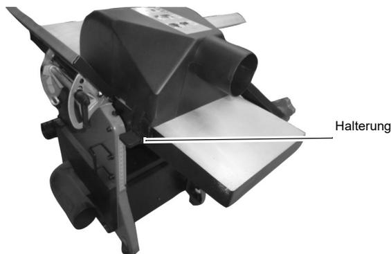
Abb. 28: Montage Späneabsaughaube
