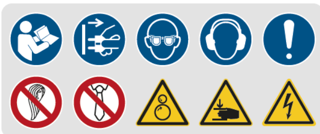
Abb. 1-1: Sicherheitskennzeichnung - Gebotszeichen: Gebrauchsanweisung beachten, Netzstecker ziehen, Augenschutz benutzen, Gehörschutz benutzen, Allgemeines Gebotszeichen | Verbotsszeichen: Bedienung mit langen Haaren verboten, Bedienung mit Krawatte verboten | Warnzeichen: Warnung vor gegenläufigen Rollen!, Warnung vor Quetschgefahr, Warnung vor elektrischer Spannung |
