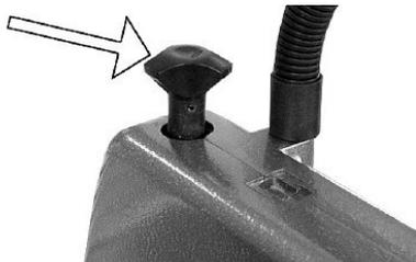
Abb. 7: Sägeblatt spannen
