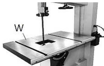
Abb. 8: Montage des Arbeitstisches
