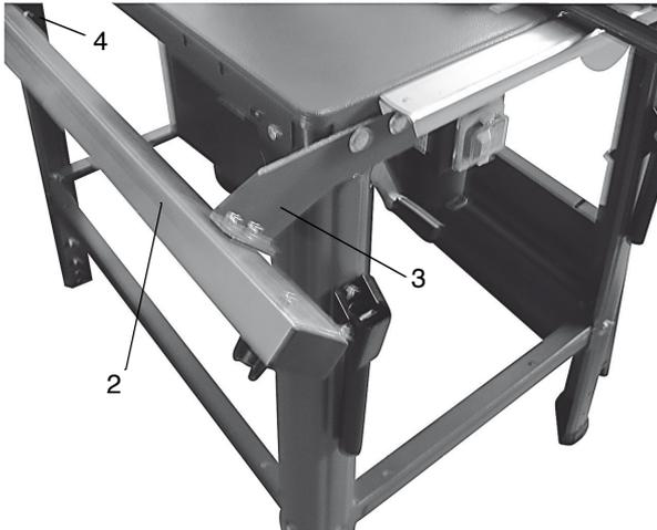
Abb. 21: Halterung und Führungsrohr montieren
