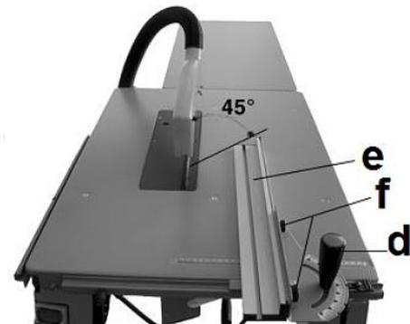
Abb. 12: Parallelanschlag in flacher Position
