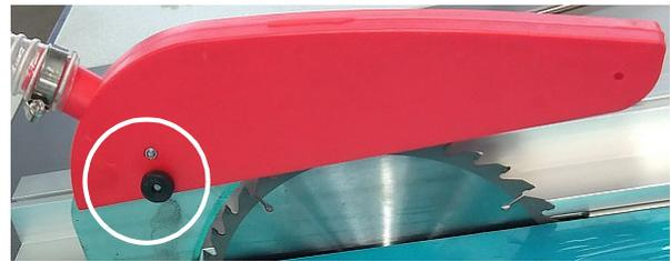
Abb. 16: Sägeblattschutz montieren
