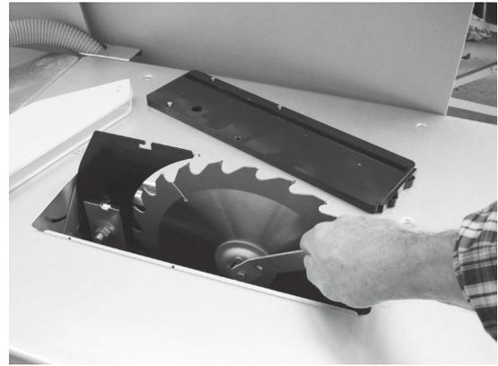
Abb. 39: Sägeblatt lösen mit dem Sägeblattschlüssel
