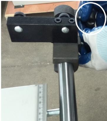
Abb. 9: Aufschieben des Trägers auf die Führungsschiene
