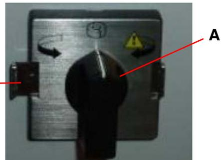
Abb. 21: Drehrichtungsschalter
