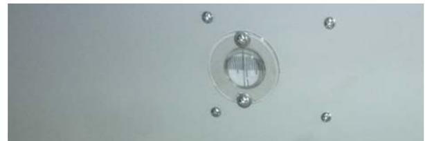
Abb. 18: Skala zur Höhenverstellung des Fräsers
