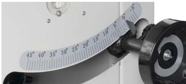
Abb. 20: Skala zur Einstellung des Fräser-Neigungswinkels
