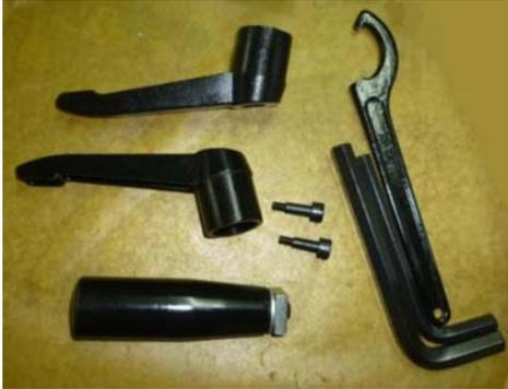
Abb. 5: Mitgeliefertes Material und Werkzeug für TF 200 SE
