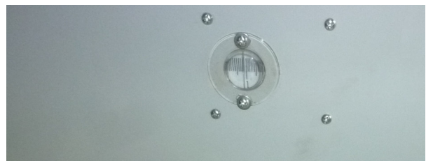
Abb. 29: Skala zur Höhenverstellung des Fräses
