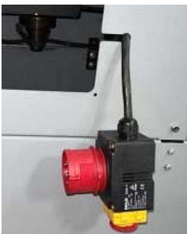
Abb. 12: Schalter befestigen
