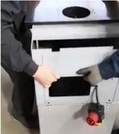
Abb. 10: Maschine auf Untergestell positionieren
