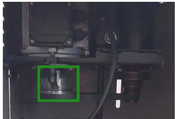
Abb. 29: Hebel Riemenspannung
