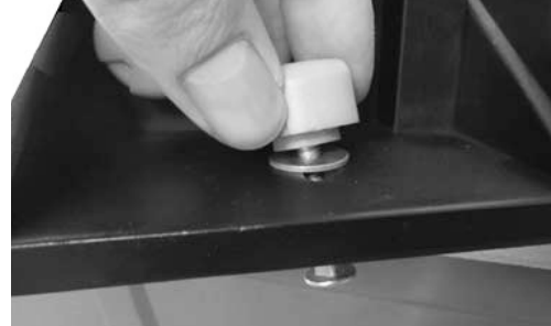
Abb. 8: Montage des Fräsanschlags
