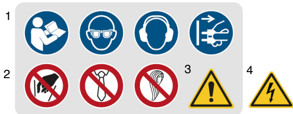
Abb. 1: 1 Gebotszeichen (Gebrauchsanweisung beachten / Augenschutz tragen / Gehörschutz tragen / Netzstecker ziehen) | 2 Verbotsszeichen (Hineinfassen verboten / Bedienung mit loser Kleidung verboten / Bedienung mit langen Haaren verboten) | 3 Allgemeines Warnzeichen | 4 Warnung vor gefährlicher elektrischer Spannung
