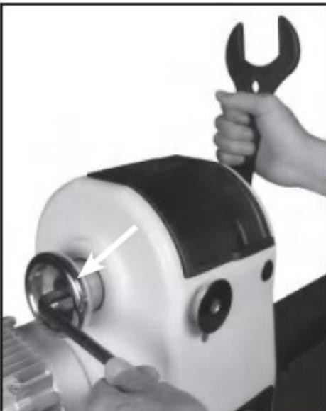
Abb. 8-21: Kontermutter der Spindel
