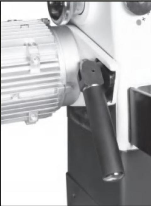
Abb. 8-20: Spannhebel des Riemens
