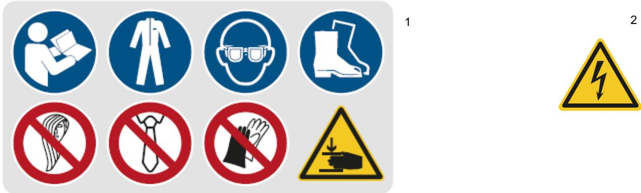
Abb. 1-2: Sicherheitskennzeichnungen - 1 Gebotszeichen: Gebrauchsanweisung/ Betriebsanleitung beachten, Schutzkleidung benutzen, Augenschutz benutzen, Sicherheitsschuhe tragen, Bedienung mit langen Haaren verboten, Bedienung mit Krawatte verboten, Bedienung mit Handschuhen verboten, Warnung vor einer Gefahrenstelle: Warnung vor Handverletzungen
