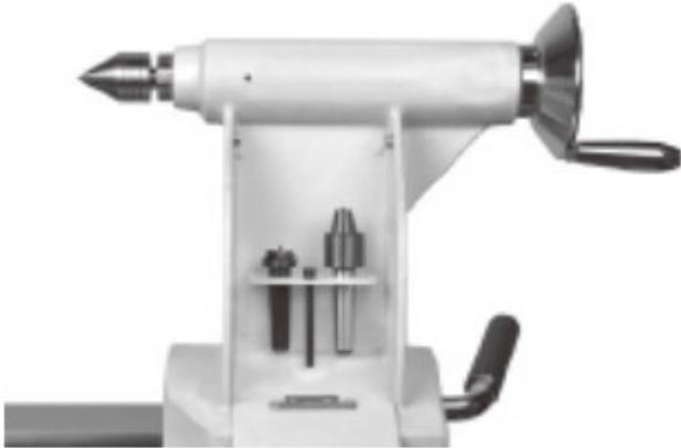
Abb.6-20: Montage des Handrads am Reitstock
