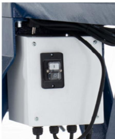
Abb. 7-11: Wechselrichter und Bedienfeld für die Hauptschalter EIN/AUS
