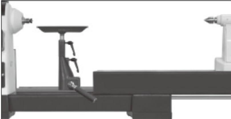
Abb.7-24: Höhenverlängerung der Werkzeugauflage
