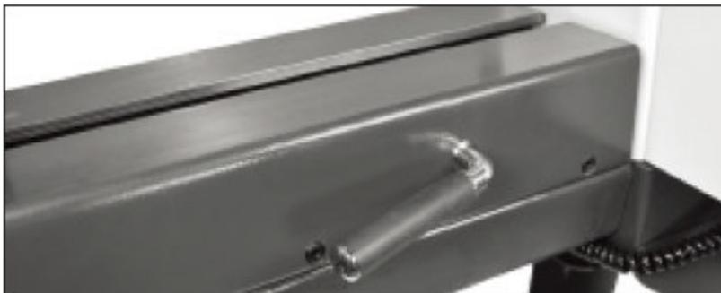
Abb.7-20: Verriegelungshebel zur Positionierung des Maschinenbettes
