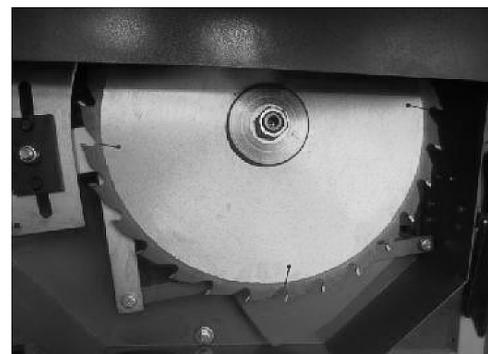
Abb. 28: Abdeckung des Sägeblattes öffnen
