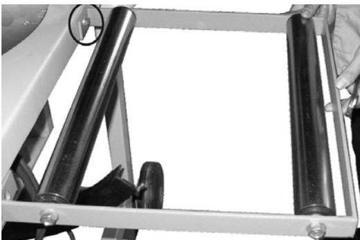
Abb. 15: Transportwalze montieren
