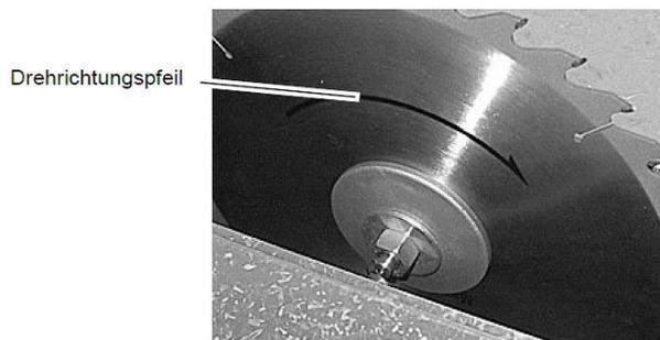
Abb. 32: Sägeblatt mit Drehrichtungspfeil
