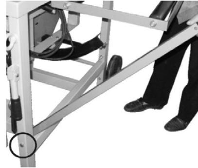
Abb. 16: Strebe montieren
