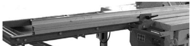
Abb. 25: Rollentisch mit Stützbeine montieren
