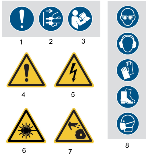
Abb. 1: Sicherheitshinweise: 1 allgemeines Gebotszeichen | 2 Netzstecker ziehen | 3 Betriebsanleitung lesen | Warnzeichen: 4 Allgemeines Warnzeichen | 5 Warnung vor elektrischer Spannung | 6 Warnung vor Laserstrahl | 7 Warnung vor Gefahr durch rotierendes Sägeblatt | 8 Gebotszeichen: Augenschutz, Gehörschutz, Handschuhe, Fußschutz und Atemschutz benutzen.
