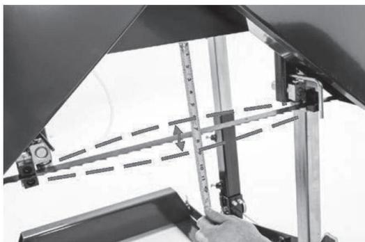
Abb.6-13: Erlaubte Abweichung bei der Sägebandspannung
