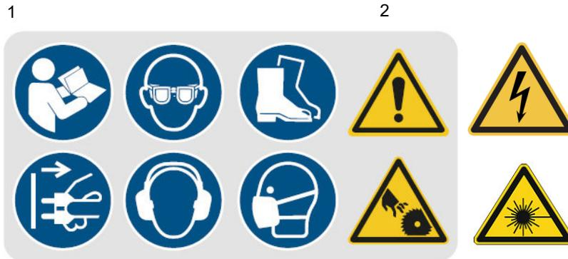
Abb. 1-1: Sicherheitskennzeichnungen - 1 Gebotszeichen: Anleitung beachten, Augenschutz benutzen, Fußschutz benutzen, Netzstecker ziehen, Gehörschutz benutzen, Maske benutzen | 2 Warnzeichen: allgemeines Warnzeichen, Warnung vor elektrischer Spannung, Warnung vor Gefahr durch rotierendes Sägeblatt, Warnung vor Laserstrahlen
